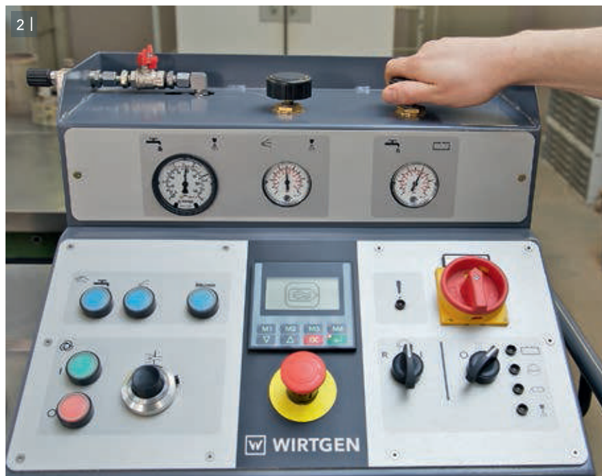
2 | Bảng điều khiển được thiết kế logic và rõ ràng cho phép dễ dàng cài đặt và giám sát các thông số làm việc quan trọng.
